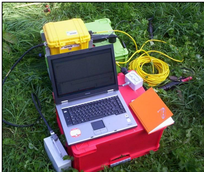
Figura 3: Strumentazione utilizzata per la prova MASW.
